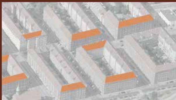
LERGRAVSPARKEN PÅ AMAGER TYPISK KARRÉSTRUKTUR, HVOR DET ER NEMT AT INTEGRERE SOLCELLER I DE SYDVENDTE TAGFLADER
