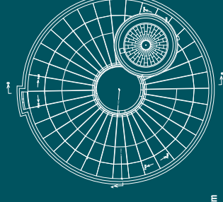
NIVEAU 4 - udgang til tag, rundgang og machicolis - i fyrtårnet desuden forvandsvassens rum
