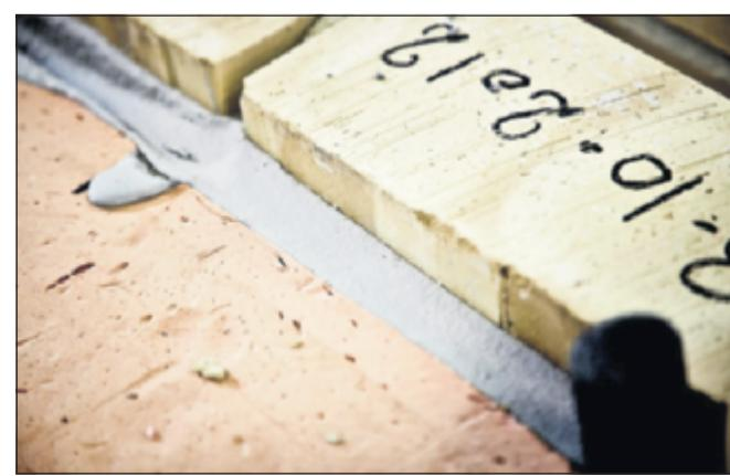
For at udnytte styrken i isoleringsmaterialet i en sandwichkonstruktion, skal der skabes forbindelse til bagmuren. Derfor foretages forsøg med forskellige typer udstøbningsmørtel.
