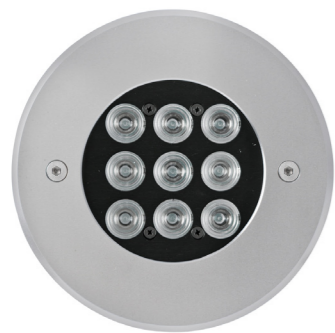
UDENDØRSBELYSNING_UP LIGHT NEDBYGGET LANGS FACADEN OG PÅ TRÆER VED ANKOMST 1200 MINI 9 LED x 1,2W (3000K)_STAINLESS STEEL ANTAL 12 STK_Ø140X225
