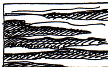
Afskalning (Alkydmaling og Plastikmaling)
