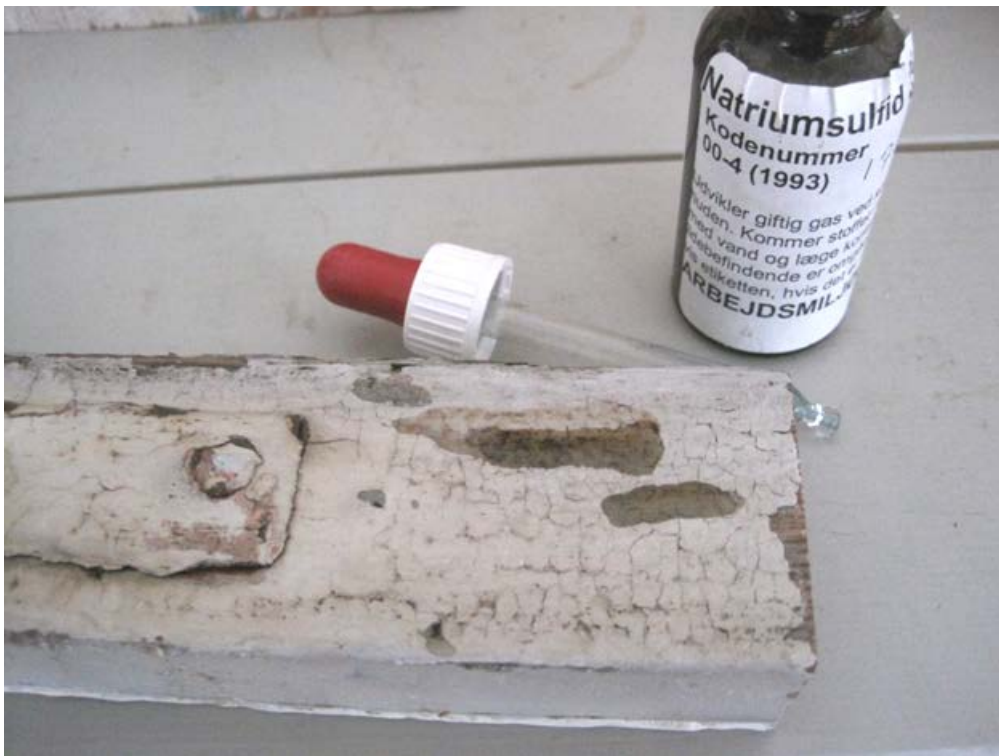
Dryptesten med Natriumsulfid – dråben farves sort, hvis der er bly i malingslaget i form af blyhvidt eller blymønje
